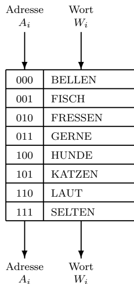
Bild 6.2: Beispiel für einen vollasoziativen Speicher, der alle Wörter des Textes aus Bild 6.1 sowie ihre Binärcodes enthält.
